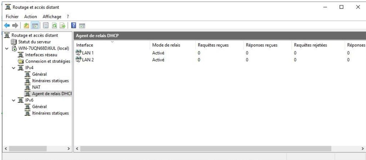
La procédure d'ajout d'agents relais sur le R2 est identique à celle du R1. À l'exception de la machine R2, il est nécessaire d'ajouter le serveur à la propriété d'Agent relais.
